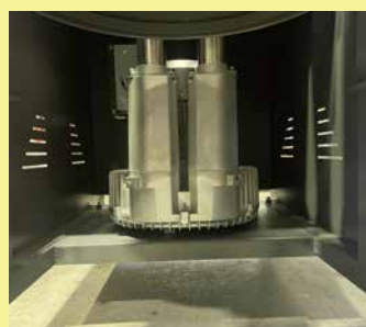
NK220ZSM 搭載の サイドチャンネルブローア
