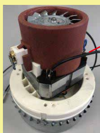
MiniBULL に搭載の ブラシ式バイパスモーター
