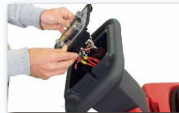
主要交換パーツはメンテナンス性の 良いはめ込み着脱式。
