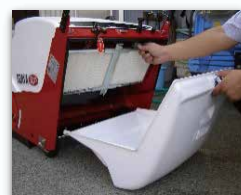
バキューム機能が付いており埃が 舞うのを軽減します。 パネルフィルターは水洗い可能です。
