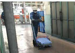
手押しスィーパーは電源不要の シンプル構造でブラシを回転させ ダストを捕集します。
