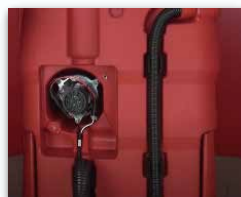
メンテナンス時バキュームモーター へのアクセスは背面取り出し口から 簡単に行えるコネクター着脱式
