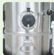
ステンレス（SUS304）タンクとダスト飛散防止キャップ
