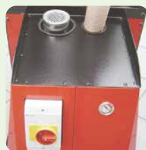
モーターの過負荷を確認出来る静圧計と逆相接続時に停止装置付
