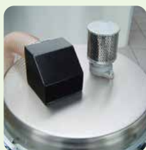
モーターの過負荷を防止するリリーフバルブはステンレスフィルター付
